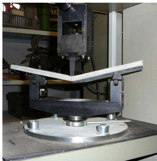
Obr. 2: Vzorek SKCO-14_4 umístěný v lisu ZWICK po zkoušce pevnosti v tahu ohybem
