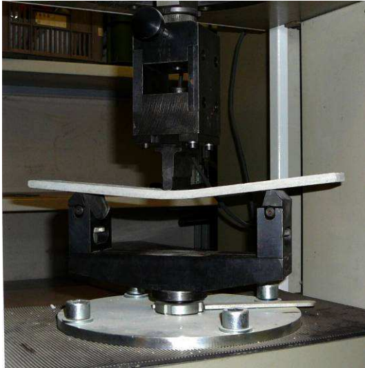
Obr. 2: Vzorek V1_1 umístěný v lisu ZWICK během zkoušky pevnosti v tahu ohybem
