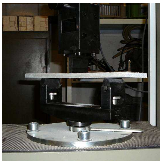
Obr. 1: Vzorek SKCO-14_4 umístěný v lisu ZWICK před zkouškou pevnosti v tahu ohybem
