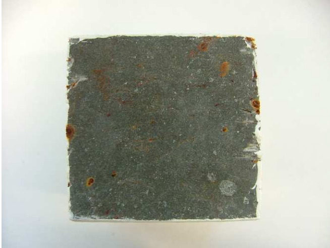
Obr. 6: Pohled na spodní nenatřenou stěnu vzorku č. 4 během zkoušky, koroze mikrovláken (stanovení vzlínivosti kolmo na směr extruze)
