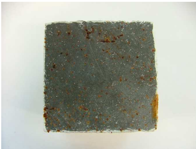
Obr. 4: Pohled na spodní nenatřenou stěnu vzorku č. 1 během zkoušky, koroze mikrovláken (stanovení vzlínavosti ve směru extruze)
