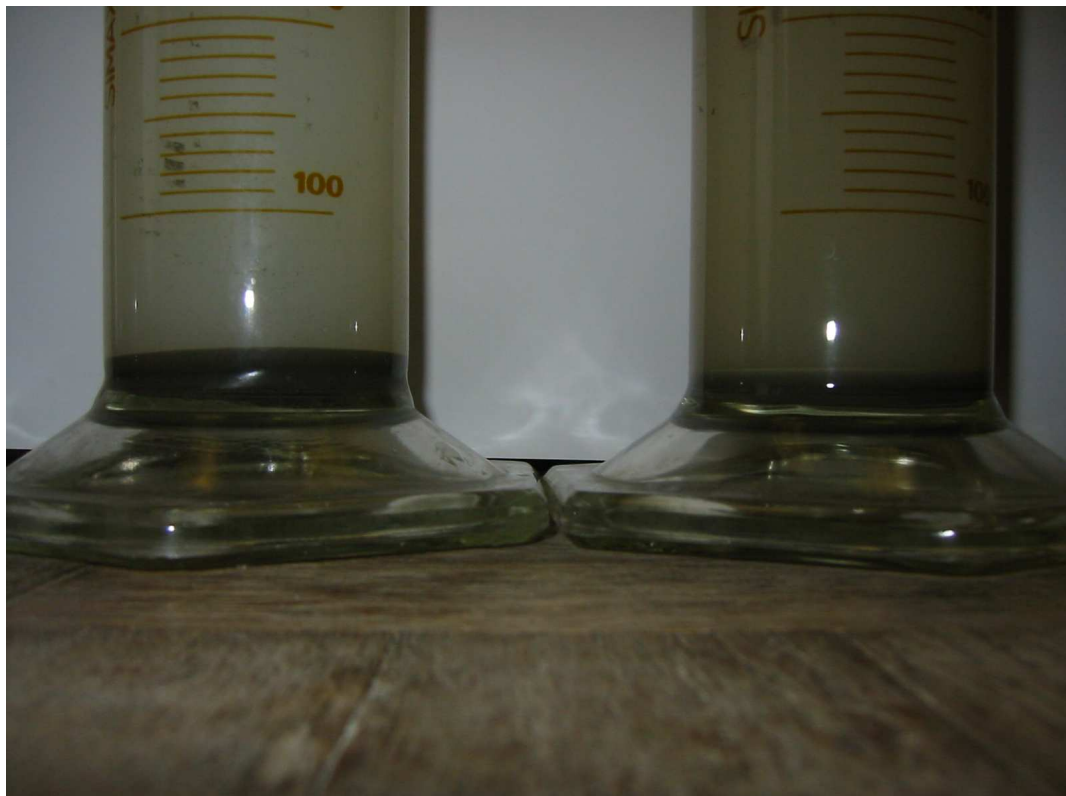
Obr. 4: Usazování portlandského cementu (V - ve vodě, G - ve vodě s Gléniem (SP1), P - ve vodě s Peraminem (SP2)), a) stav po 24 hodinách, b) stav po 48 hodinách, c) Detailní pohled na objem, který zaujaly usazené částice po 48 hodinách (SP1 x SP2)
