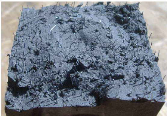
Obr. 4) Lom vzorku s obsahem ocelových mikrovláken v množství 1,3%
