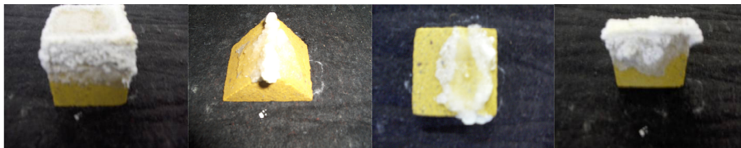
Obrázek č. 3 : nárůst výkvětu po 4 denním umístění vzorků v 5 % roztoku \text{Na}_2\text{SO}_4
