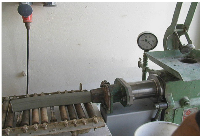
Obr.5: Modifikovaný cihlářský lis firmy Händle pro potřeby extruze
